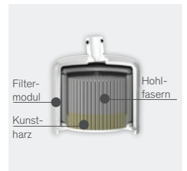
Querschnitt BIOFIL Filter
